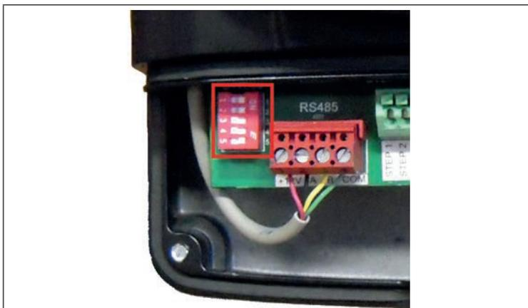
Posizione degli switch per il comando mediante iQPUMP
