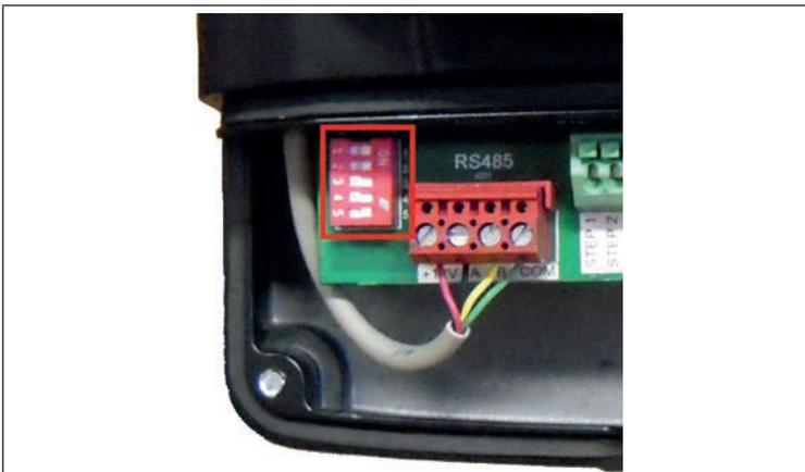
Posizione degli switch per il comando mediante AquaLink® TRi
