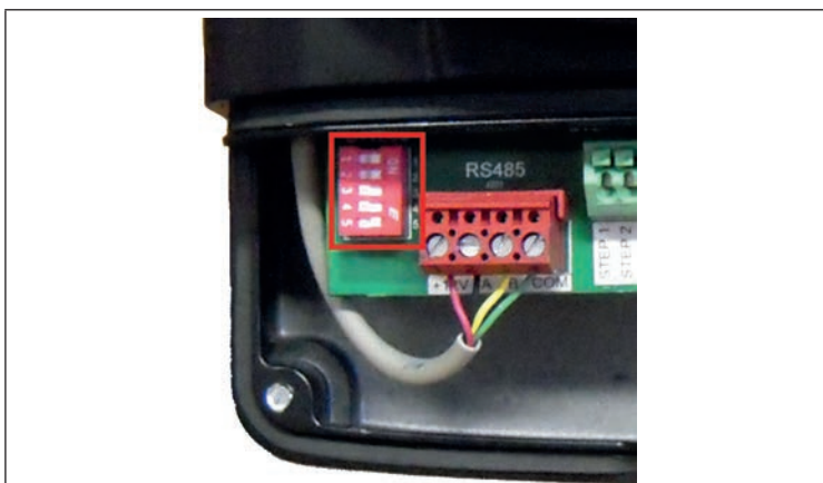
Position des switches pour le pilotage par iQPUMP
