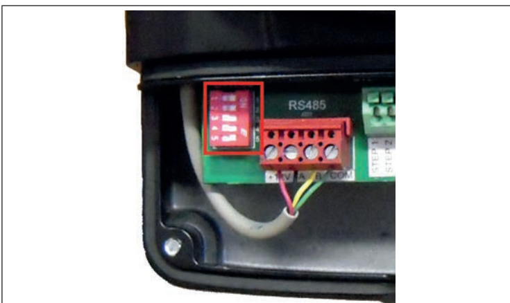
Position des switches pour le pilotage par AquaLink® TRi
