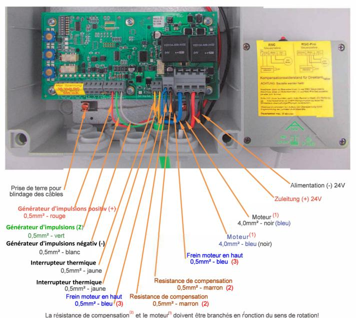
La résistance de compensation<sup>(2)</sup> doivent être branchée dans le bloc de raccordement inférieur, le frein moteur<sup>(3)</sup> dans le bloc de raccordement supérieur!
