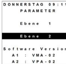
15) Den Code „-19“ eingeben, um zum Menü zu gelangen, dann den Parameter P80 auf 10 einstellen (um die Betriebsstufe des Ventilators zu erhöhen)
