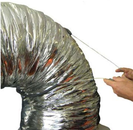
9) Den Draht um das Schutzrohr wickeln, das Plastikrohr so anbringen, dass es das Gebläserohr schützt.
