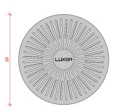
Ansauggeschwindigkeit: bei 0,5 m/S = 35 m³/h
