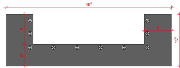
PVC-Platte wird nach dem betonieren an den Skimmer angeflanscht.
