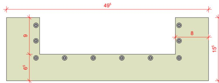
PP-Platte wird nach dem betonieren an den Skimmer angeflanscht. Abdichtung mit Innotec Adheseal oder Rotabond.
