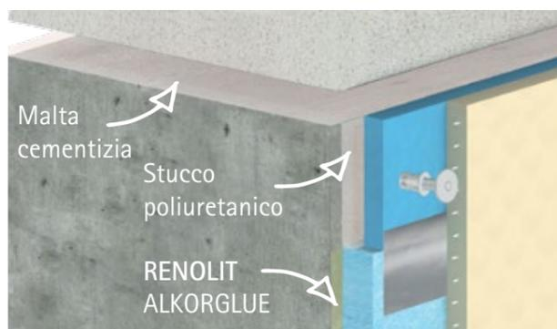
Nel caso delle ristrutturazioni, per non dover smontare il bordo in pietra, utilizzeremo il profilo colaminato standard. Il profilo colaminato si adatta perfettamente a qualsiasi forma delle pareti della piscina.
