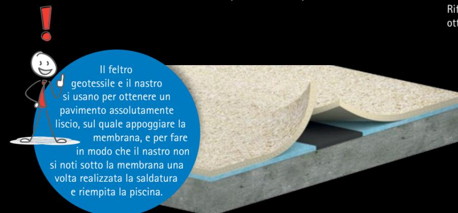
Il feltro geotessile e il nastro si usano per ottenere un pavimento assolutamente liscio, sul quale appoggiare la membrana, e per fare in modo che il nastro non si noti sotto la membrana una volta realizzata la saldatura e riempita la piscina.
