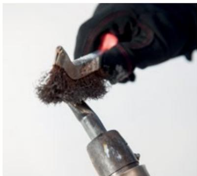
Prima di iniziare a saldare, pulire l'ugello dell'apparecchio di saldatura con una spazzola di metallo e verificare che la membrana da saldare sia pulita e asciutta passando un panno asciutto e pulito o carta da cucina.
