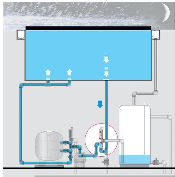
Im Sparbetrieb (Ansaugung direkt aus dem Becken) fließt das Wasser nicht über die Rinne. Die Verdunstung und damit der Energieverlust wird stark reduziert. Mit einer Investition von ca. € 3'000 können Sie somit pro Saison mindestens 10'000 kWh einsparen. Zusätzlich erhalten Sie eine automatische Rückspülung.
