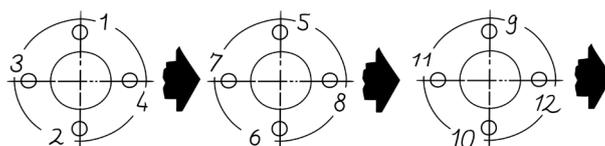
Anzugsdrehmoment für Einringdichtung 4 Nm bei M6
