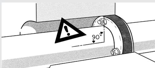
**4.** Zum Einbau die Rohre oder Kabel durch die entsprechenden Bohrungen in der Dichtung schieben (evtl. mit Seifenlauge oder Silikonspray einsprühen) und zusammen in die Kernbohrung bzw. in das Futterrohr einführen.
