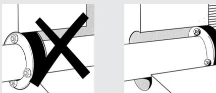
**3.** Auf rechtwinkligen Einbau der Dichtung zur Kernbohrung bzw. Futterrohr achten!
