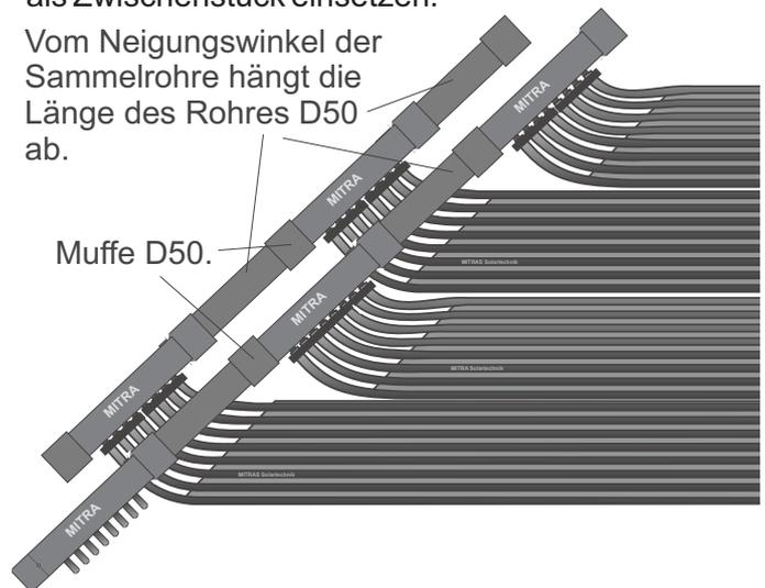
Befestigen Sie zuerst auf der Absorbermontagefläche die Mattenhalter. Dann fixieren Sie die Absorber mit den Mattenhaltern und schneiden sie an den Schrägseiten (Sammel- und/oder Endrohrseite) ca. 10 cm länger als notwendig ab.
