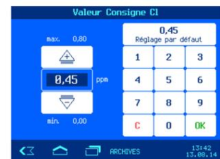
Réglage par défaut: 0,45 mg/l      Plage de réglage: 0,0 à 0,8 mg/l
