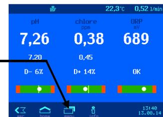
Le processus commence par l'étalonnage du point supérieur (pH 7). Pour ce faire, l'électrode pH doit être plongée dans la solution tampon pH 7. L'écran affiche la valeur mesurée par l'électrode pH. Une fois la valeur affichée à l'écran stabilisée, il convient soit
