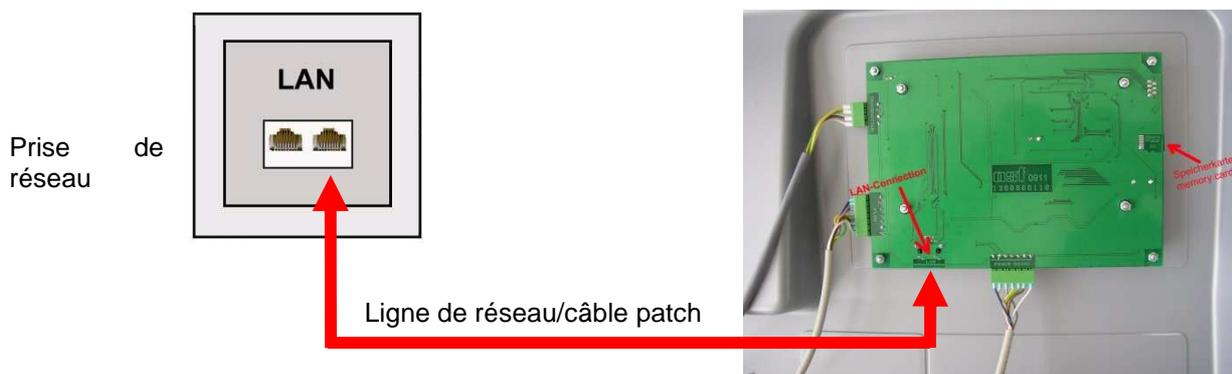
Une fois le WATERFRIEND connecté au réseau local, il peut être mis sous tension. Le serveur Web osf du WATERFRIEND recherche automatiquement le serveur de communication osf et se connecte à la base de données.
