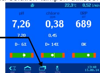
L'électrode redox doit être plongée dans la solution tampon 468 mV. L'écran affiche les valeurs mesurées par l'électrode redox. **L'écart entre la valeur affichée et la valeur de la solution tampon (468 mV) ne peut excéder ± 10 %. En cas d'écart plus important ou de temps de réaction prolongé, remplacez l'électrode dans les plus brefs délais.**
