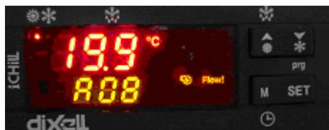
L'affichage signale la sollicitation par le biais de la LED en haut à gauche. La température de l'eau indiquée correspond à la valeur effective actuelle. A la ligne 2, les codes d'erreurs signalent les anomalies. La signification est indiquée dans le tableau.
