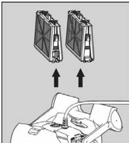
**9.1.1** Ouvrez les couvercles des filtres et retirez les cartouches des deux côtés du robot
