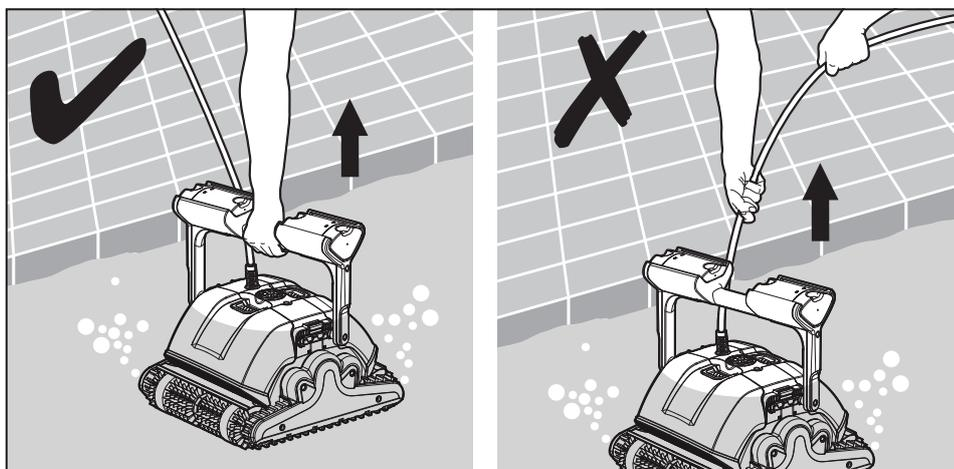
**7.4.3** Déposez le robot nettoyeur sur le bord de la piscine et laissez l'eau s'écouler.
