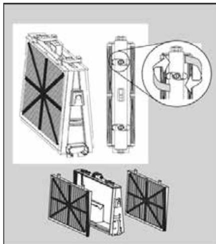
**9.1.2** Ouvrez les attaches et retirez les filtres.
