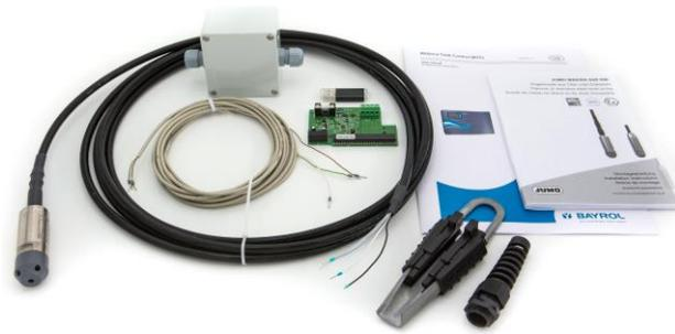
Die Schwallwasserbehälter-Steuerung ist eine Erweiterungs-Option für BAYROL PoolManager®, PoolManager® PRO und Analyt Pool-Steuerungen. Sie misst den Füllstand im Schwallwasserbehälter bei Becken mit Überlaufrinne in Zentimetern. Für die Messung wird ein sehr robuster hydrostatischer Sensor (Drucksensor) aus Titan verwendet. Der Sensor liefert ein 4-20 mA Messsignal.
