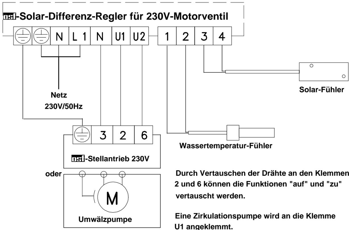
**Bei Verwendung von Stellantrieben anderer Hersteller bitte den Anschlußplan des Stellantriebes beachten!**
