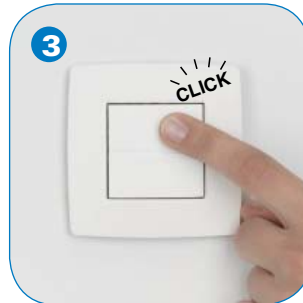
3 Der zugehörige Taster wird betätigt (die rote LED und auch die angeschlossenen Lampen blinken zur Bestätigung 2x auf)
