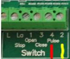
Schließen Sie 2 Drähte mit Nr. 4 und 2 (pulse) wie oben im ECB-Steuerbox und verbinden Sie diese Drähte mit Nr. 8 und 9 im Fernbedienungsempfänger.
