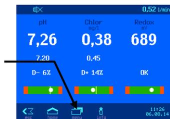
Im ersten Schritt wird der obere Punkt (pH 7 kalibriert). Dazu wird die pH Elektrode in die Pufferlösung pH 7 eingetaucht. Im Display werden die aktuellen Werte der pH Elektrode angezeigt. Ändert sich der angezeigte Wert in im Display nicht mehr, ist entweder
