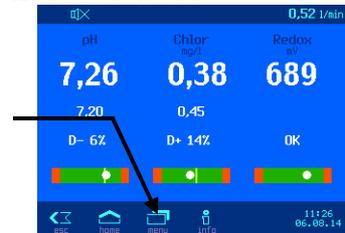
Die Redox-Elektrode wird in die Pufferlösung 468mV eingetaucht. Im Display wird der aktuellen Werte der Redox-Elektrode angezeigt. **Die Abweichung zwischen dem angezeigtem Wert und dem Wert der Pufferlösung (468mV) sollte  $\pm 10\%$  nicht überschreiten. Bei größerer Abweichung oder verlängerter Reaktionszeit sollte die Elektrode kurzfristig ersetzt werden.**
